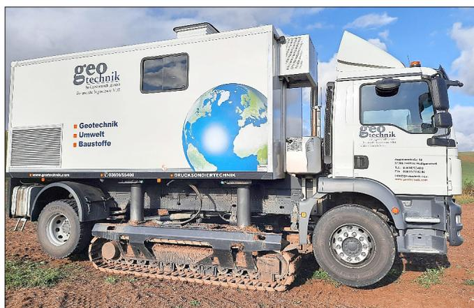
Firma Geotechnik bei der Drucksondierung des Baugrundes; eine Firma aus Heiligenstadt, am 12. Oktober 2021, hier bei Höngeda
